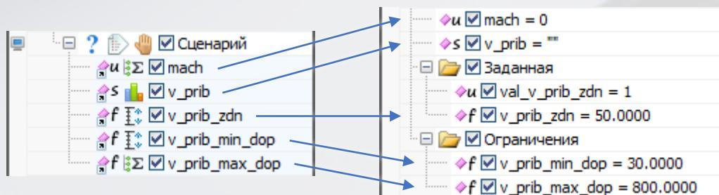
При отработке сценария, его элементы последовательно выполняются с присвоением новых значений входным переменным. На каждый элемент сценария назначается один из 3 встроенных в САПР видов эмуляции данных.
