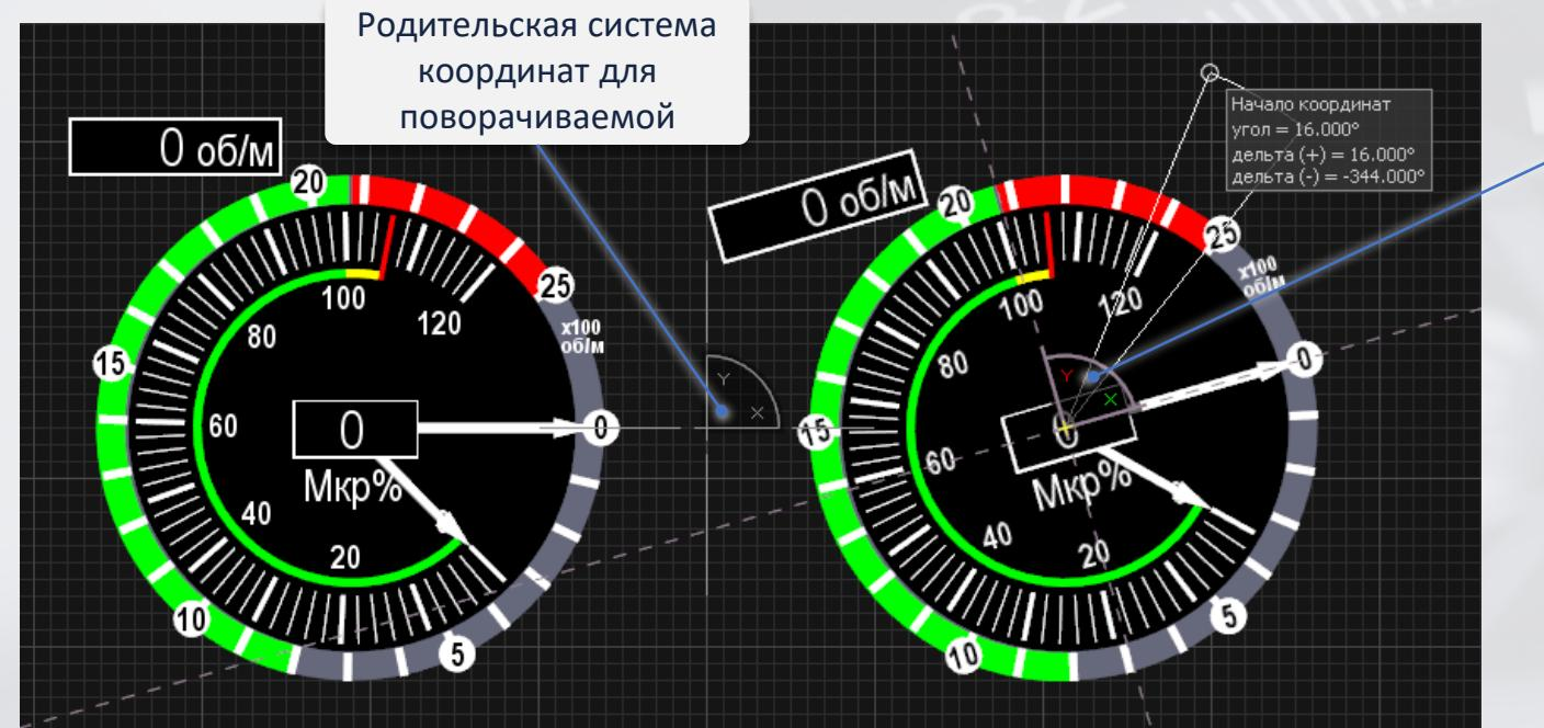
Это упрощает создание визуальных эффектов, а также компоновку графики на экране. Фрагменты индикационного кадра создаются в отдельных системах координат. Если необходимо сместить или повернуть фрагмент, то достаточно сместить или повернуть систему координат, в которой он создан, без изменения координат входящих в него примитивов.
